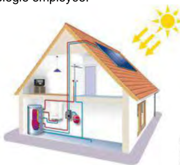
Figure 28 : Schéma de principe de fonctionnement des capteurs solaires thermiques
